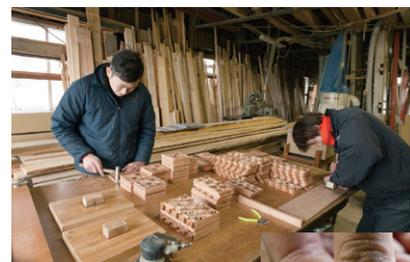
ここは、約300年続く大川組子の伝統の中で福岡県現代の名工の遺伝子を受け継ぐ建具製作所です。組子の加工は、非常に繊細な技術が必要とするため、0.001ミリ単位を感覚で判断しなければならないとのこと。計算され尽くしたデザインに合わせ精密な角度に、長年の経験でしか得られない職人の腕と感覚で生み出されます。釘を一切使わない組子細工において、仁田原建具製作所では積極的に新しい手法を取り入れながらも、職人の感覚が要となる部分では妥協を許さない独自の手加工技術を用いてさらに良いものへと日々ものづくりを進化させています。
